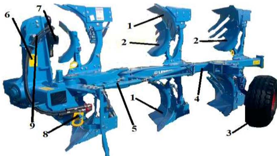
82- rasm. Europal 5 2+1 plugini umumiy ko‘rinishi: 1 va 1’ o‘ng va chap tomonga ag‘daradigan korpuslar; 2-chimqirqar; 3- tayanch g‘ildirak; 4-rama; 5- Optiquick mexanizmlari; 6- plug ustuni; 7- plugni to‘ntaradigan gidrosilindr; 8- pastki bo‘ylama tortqilarni ulaydigan barmoq; 9- markaziy tortqi ulanadigan cho‘ziq va dumaloq teshiklar:
