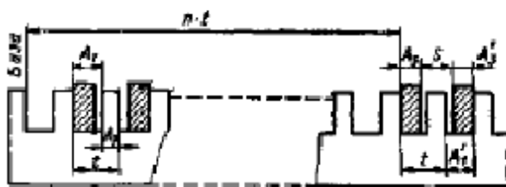
7.11-rasm. Taroq pazlarini va kolosniklarni o'rnatish sxemasi
