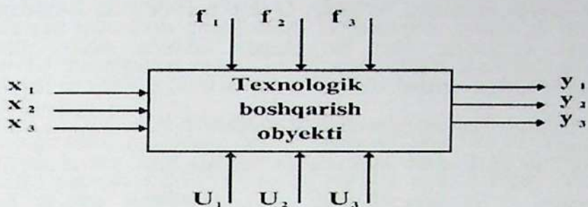
15-rasm. Boshqarish ob'ekting parametrik sxemasi.
