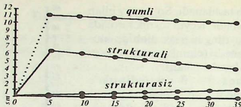
14-rasm. Tuproqning suv o'tkazuvchanligini aniqlashda tuproq qatlamining ustki qismidan pastki qismiga turli xil tuproqlardan ma'lum vaqt ichida naycha bo'ylab suvning o'tish chizmasi.
