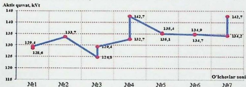
3.6-rasm. Nasos agregatiga o'rnatilgan chastota o'zgartirgichi qurilmasining turli oraliq chastotalarda ishlash davrida quvvatning o'zgarishi.
