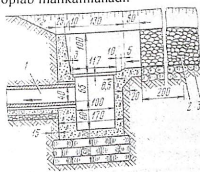
5.5. – rasm. Kirish og'zining konstruksiyasi.
