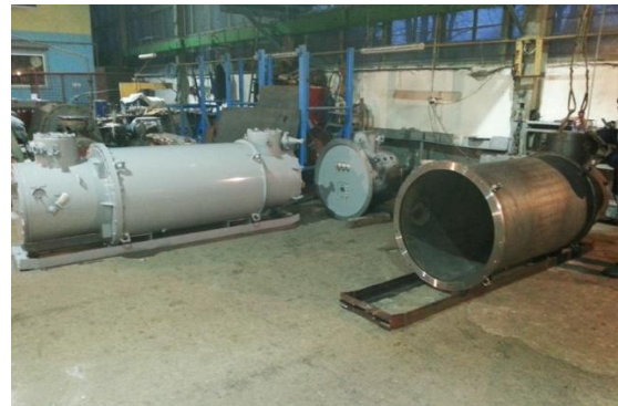
4.13-rasm. KTIIB markali shaxtalar uchun mo'ljallangan portlashga xavfsiz quruq transformator.
