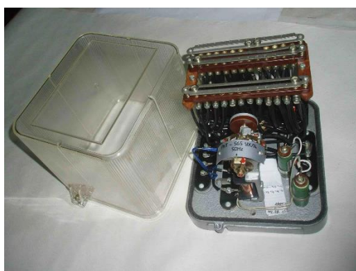
6.43-rasm. PHT-565 turidagi rele: a – umumiy ko'rinishi, b – ulanish sxemasi.
