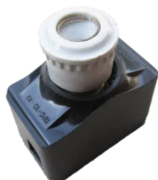
5.1-rasm. Probkali saqlagich: 1 va 2 – qisqichlar. 3 – eruvchan qo‘yilma. 4 – probka. 5 – kolodka.
