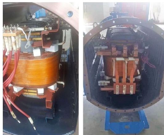
6.44-rasm. TSSH seriyali kuch transformatori.
