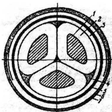
4.15- rasm. 10 kV kuchlanishga mo'ljallangan uchta sektorial payli va belbog' izolyatsiyali kabelning ko'ndalang kesimi: 1 – tok o'tkazuvchi pay; 2 – faza izolyatsiyasi; 3 – belbog' izolyatsiya; 4 – to'ldirgich; 5 – qo'rg'oshin qobiq; 6 – zirx tagidagi bitum singdirilgan qog'oz va kalavadan tashkil topgan yostiq; 7 – ruxlangan ikkita qalinligi 0,8 mm lentadan iborat zirx.
