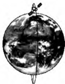
1.38-rasm 2 . Ekvator va orbita tekisliklari orasidagi burchak 90^0 ga teng. Bu orbita qutbiy deb nomlanadi.
