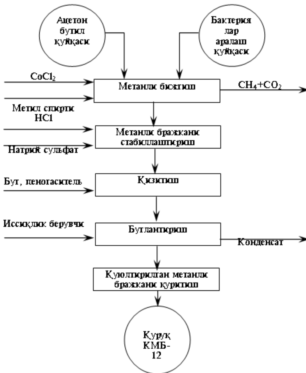
7.3.-чизма. Озуқа концентрати V_{12} - витаминини ишлаб чиқаришнинг технологик чизмаси
