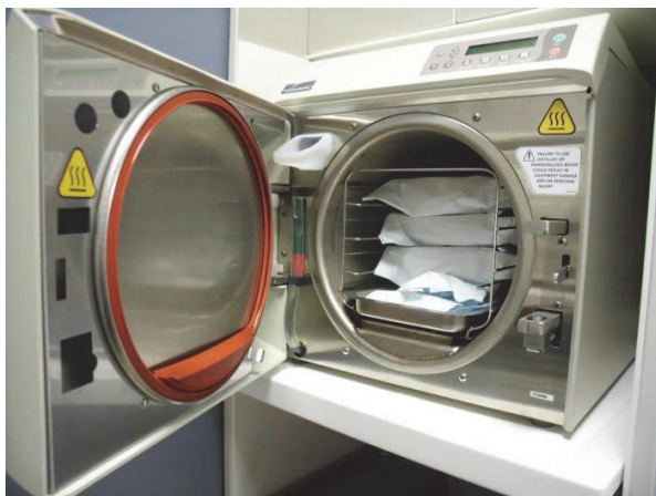
Şəkil 3.7. Hava metodu ilə sterilizə aparatı
