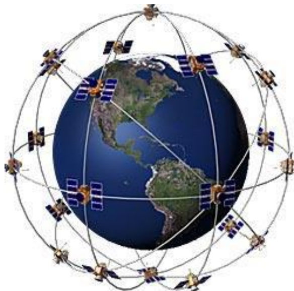
3.27-rasm. GPS sun'iy yo'ldoshlar tizimini orbitada joylashuv sxemasi.
