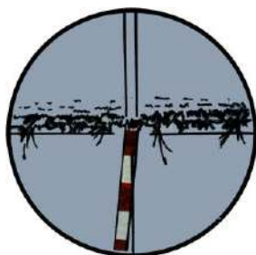
54- rasm. Nuqtaga qaratish va trubaning ko`ruvchi maydoni.
