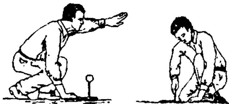
33-rasm. Joyda chiziq uzunligini lentada o'lchash
