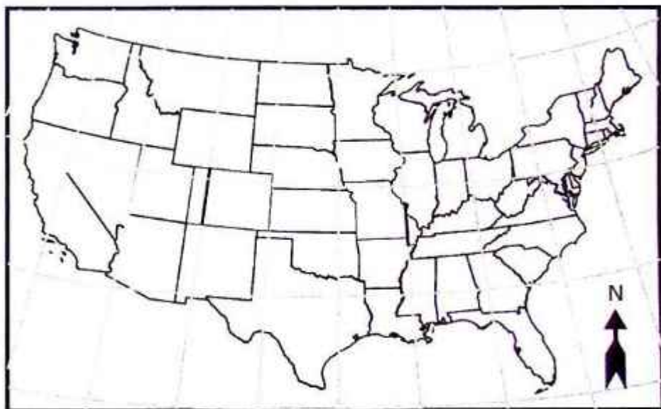
3.12—rasm. Agar meridianlar aylanib chiqsa yoki qayrilgan bo'lsa, shimol strelkasi ishlatilmasligi kerak. Ushbu konusli proyeksiyada strelka shimolni ko'rsatmaydi.
