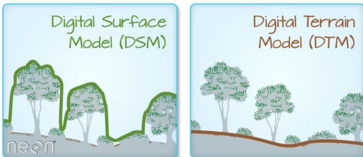
1.5-rasm. Raqamli sirt modeli (DSM) va Raqamli yer modeli (DTM) (manba: https://github.com/DahnJ/Awesome-DEM )
