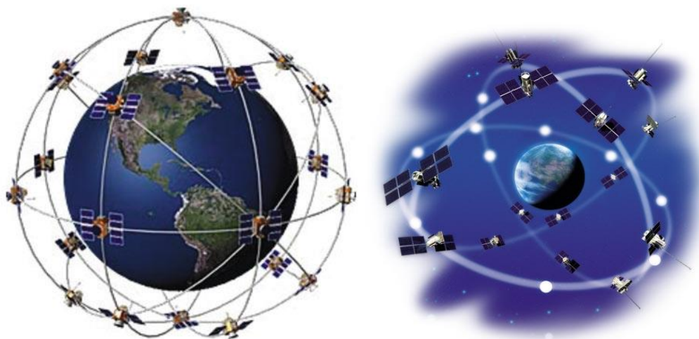
6.1-rasm:GPS sun'iy yo'ldoshlarning orbitadagi shematik joylashuvi.
