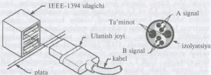
7.8-rasm. IEEE-1394 shinaning kabeli, ulanish joyi va ulovchisi.
