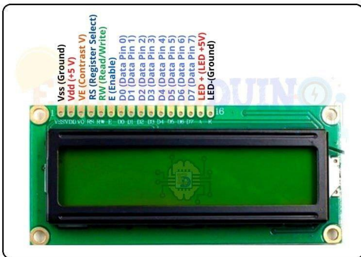
62-rasm. LCD displeylari pinlarini funksiyalari ulanish ko'rinishi.
