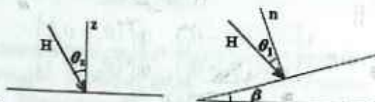
10.6-расм. Қия ва горизонтал юзалар учун қуёш нурунинг тушиш бурчаклари.
