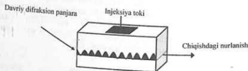
4.3- rasm. Taqsimlangan teskari aloqali yarim o'tkazgichli lazer diodi
