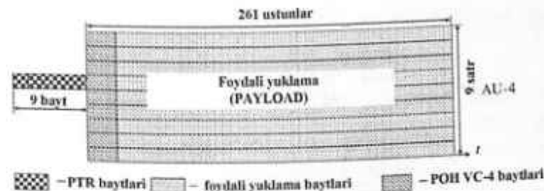
6.11-rasm. AU-4 administrativ blokni virtual VC-4 konteyner bilan yuklash
