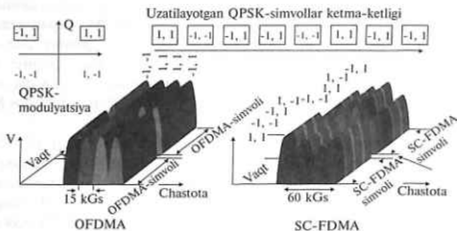
20.7-rasm. QPSK – simvollar ketma-ket uzatilishida OFDMA va SC-FDMA orasidagi farq.
