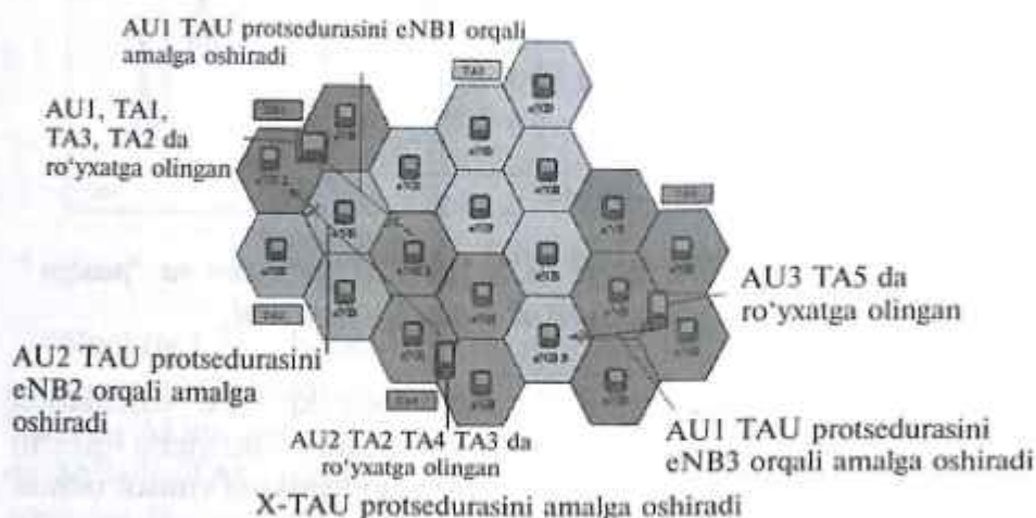
16.5-rasm. "Noaktiv LTE" holatida ko'p sonli TAlar sxemasining ishlashi.
