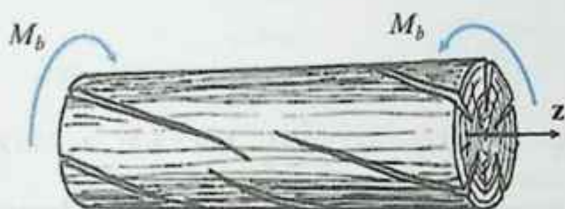
7.7-rasm. Doiraviy kesimli yog'ochning buralish deformatsiyasidagi buzilishi.
