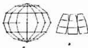
5.1-rasm. Yer ellipsoidini trapetsiyalarga bo'linishi
