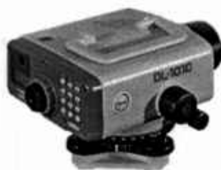
9.13-rasm. DL-101C, DL-102C TOPCON raqamli nivelirlari
