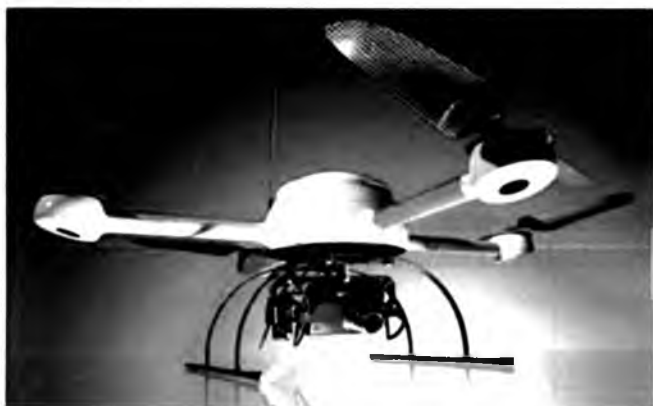
1.29-rasm. Uchuvchisiz aerofotsyomka olib borish uchun mo'ljallangan maxsus platforma MD4-1000 (Germaniya) raqamli antenna kamerasi, termal tasvirlash kamerasi, yaqin infraqizil kamera va videokamera bilan jihozlangan.
