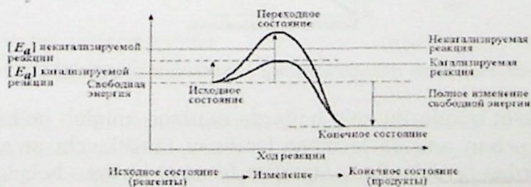
5-рasm. Fermentning energiya to'sig'iga ta'siri va reaksiyaning faollanish energiyasi.
