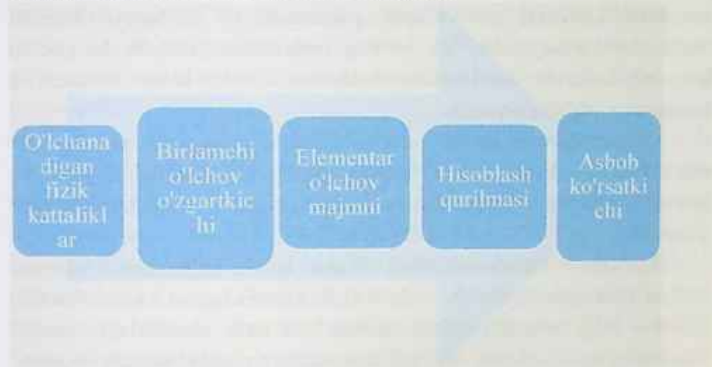
6.7-rasm. O'lchash asboblarning umumlashgan strukturaviy sxemasi
