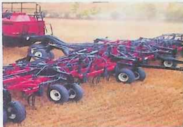
29-rasm. VERSATILE DH-730 rusumidagi qishloq xo'jaligi ekinlarini ekishga mo'ljallangan pnevmatik seyalka.
