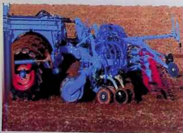
24-rasm. LEMKEN. Compakt-Solitaire-9K rusumidagi kombinatsiyalashgan seyalkasi.
