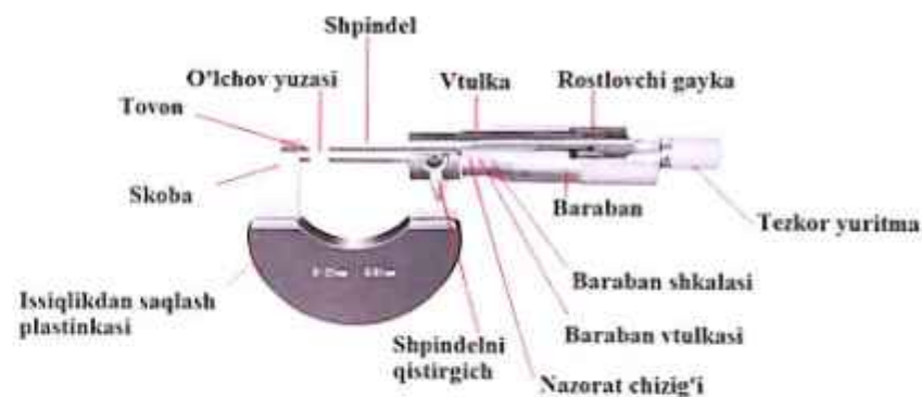
12-rasm. Mikrometrning asosiy detallari.
