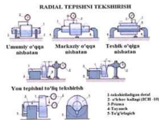
133-rasm. Radial va yon yuza tepishlarni nazorat qilish.
