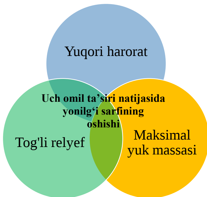
1.3-rasm. Eksploatatsion va iqlim omillarining yonilg'i sarfiga sinergetik ta'siri diagrammasi
