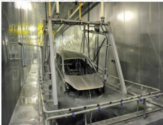
1-rasm. Avtomobil kuzoviga bo'yoqdan oldin ishlov berish
