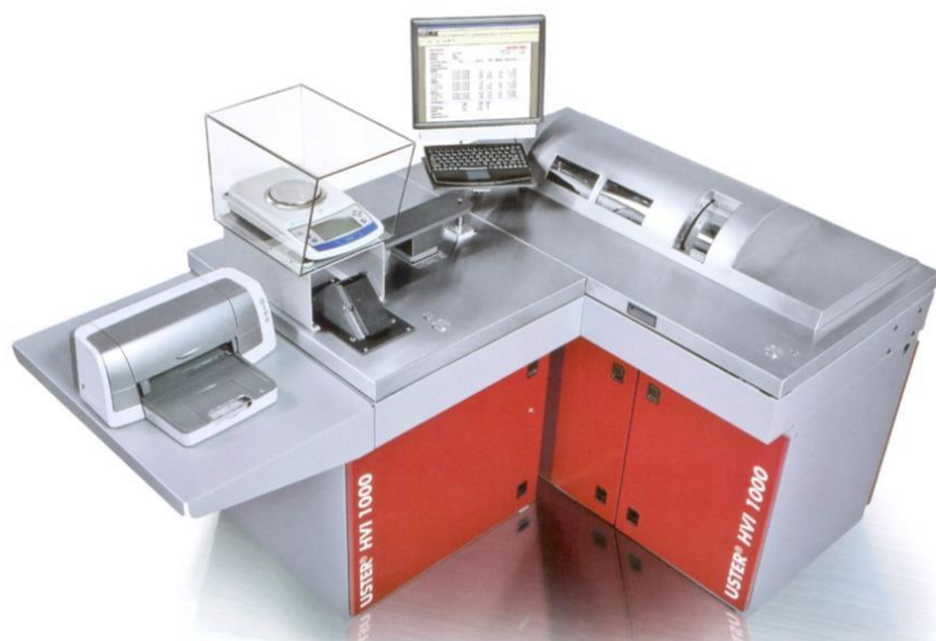
3.1-rasm. Tolaning to'liq xossa ko'rsatkichlarini aniqlashda ishlatiladigan
