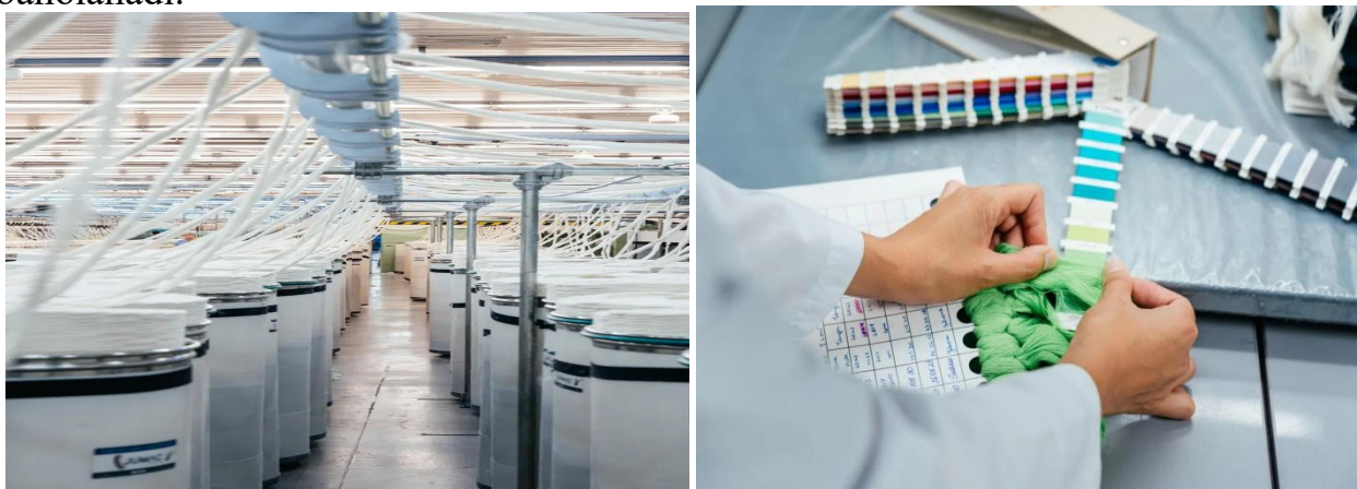
2-rasm. Melanj iplari uchun ip va tolalarni bo'yash, sifatini nazorat qilish.
