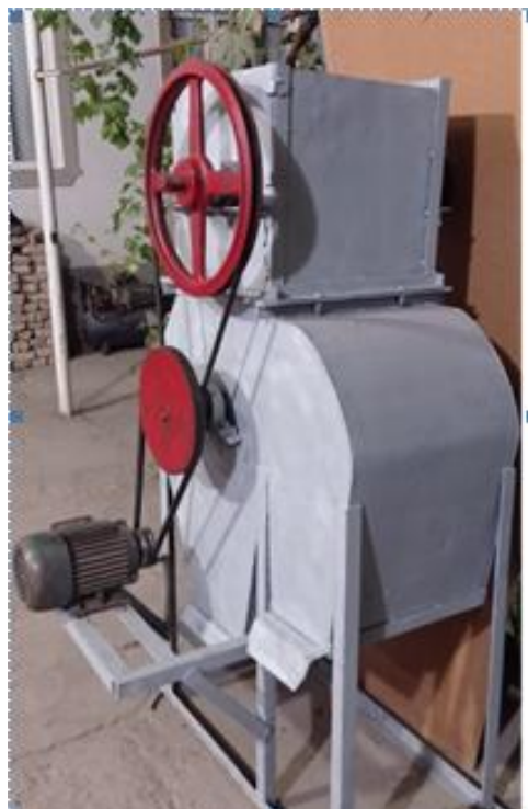
1-rasm. 1-ta'minlovchi valiklar, 2-qoziqchali-plankali baraban, 3-to'rtli yuza, 4-ifloslik bunkeriga, 5-tozalangan paxta chiqish bo'g'izi.
