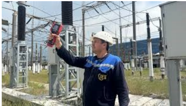
3-rasm. Energetika tizimlarida termografik nazorat jarayoni
