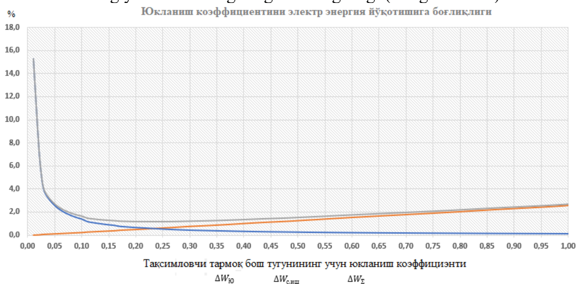
2-rasm. LK-102-2-1 taqsimlovchi tarmoq yuklanish koeffitsientiga bog‘liq elektr energiya isroflarining o‘zgarishlar grafigi (%).
