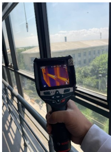
2-rasm. Sanoat binosi ichki qismlarining termogrammasi.
