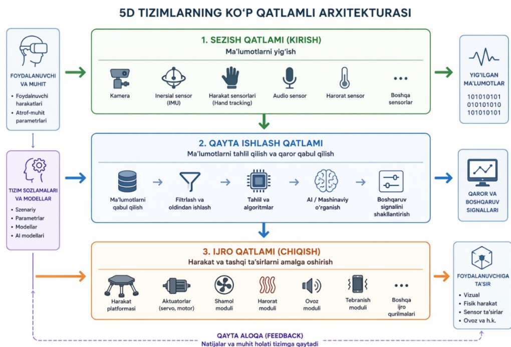
1-chizma. 5D tizimlarining ko'p qatlamli arxitekturası
