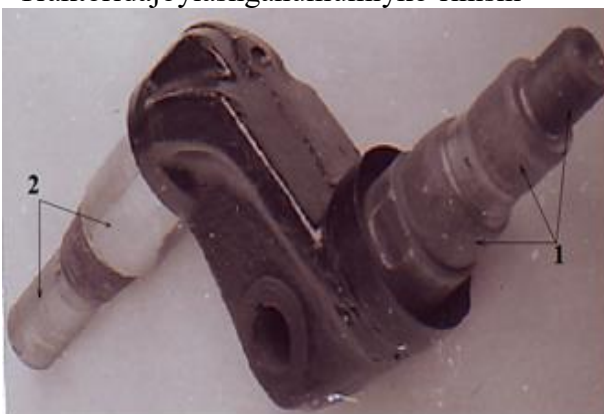
Rasm-3. Tiklangan tirsakli o'qning umumiy ko'rinishi 1-qoplangan yuzalari; 2-mexanikishlov berilgan yuzalar
