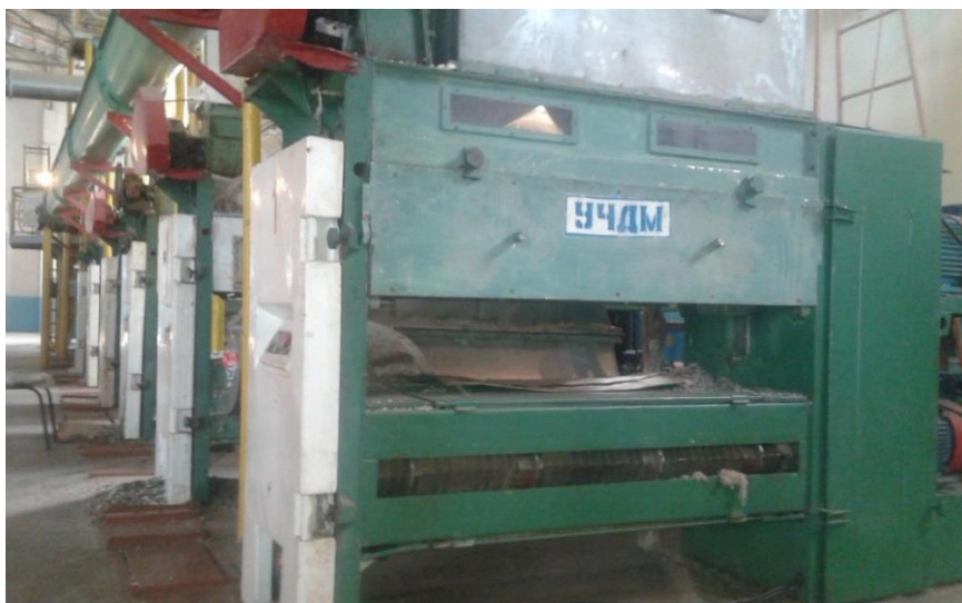
1-rasm. Takomillashtirilgan arra-metall cho'tkali barabanlar o'rnatilgan UCHDM delinterini tuksizlantirilgan urug'lik chigit tayyorlash sexiga o'rnatilgan va ish xolatiga keltirilgandagi umumiy ko'rinishi
