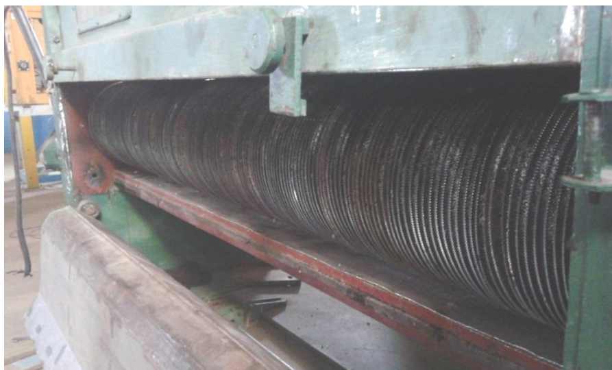
2-rasm. Takomillashtirilgan arra-metall cho'tkali barabanlar o'rnatilgan UCHDM delinterini yuqori ishchi kamerasiga o'rnatilgan natural o'lchamdagi arra-metall cho'tkali barabanlarni ish xolatidagi ko'rinishi
