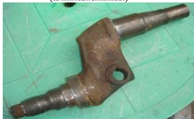
Rasm-4. Turdosh traktorlarning qayta tiklangan tirsakli o'qlarining umumiy ko'rinishlari
