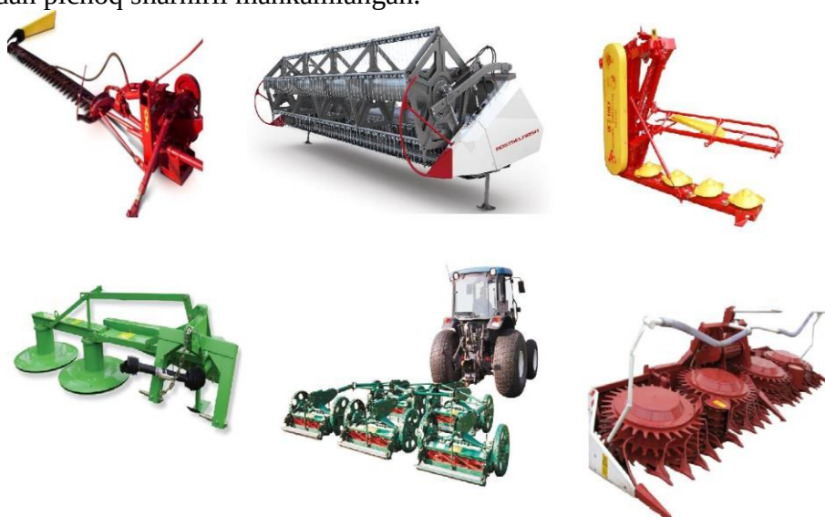
2-rasm. O'rish apparatlarining tashqi ko'rinishi bo'yicha har xil turlari
