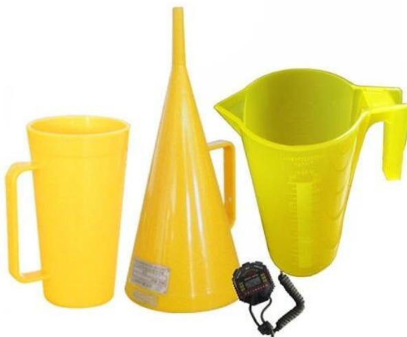
2 - rasm. MLN-3 modelidagi Marsh viskozimetri va voronkasi
