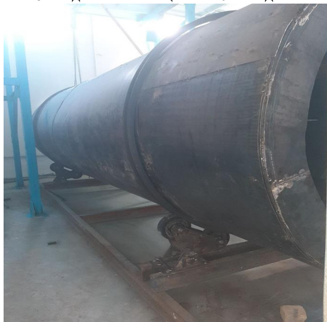
Рисунок 1. Общий вид изготовленного малогабаритного сушильного барабана
