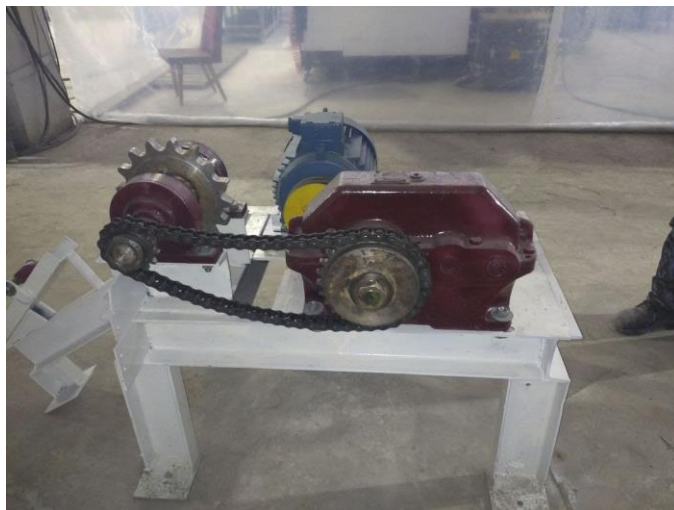
Рисунок 2. Общий вид ведущего привода к барабанной сушилке.
