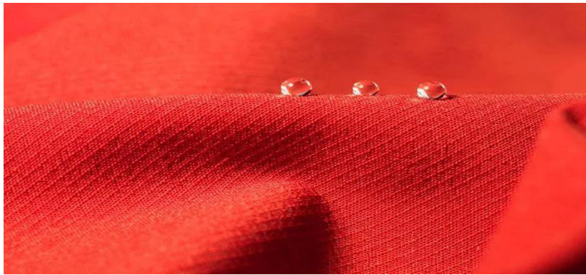
1-rasm. Mato sirtini suvga suv o'tkazmaslik hususiyati.
