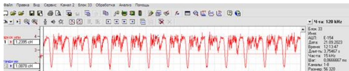
Рисунок 4 — Тензограмма натяжения с толщиной уточной нити 30 текс в цикле работы ткацкого станка
