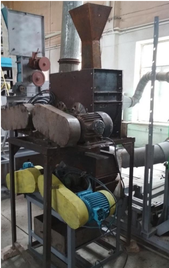
4-расм. УЧДМ машинаси стендининг юқори ва пастки камераларини бирлаштириб йиғилган ҳолати
