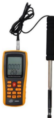
1-расм. Hot Wire GM8903 русумдаги анемометр
