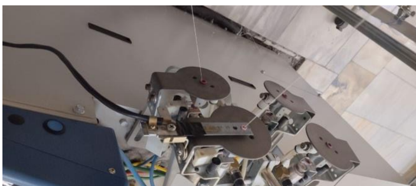
Рис.1. Расположение датчика на ткацком станке
