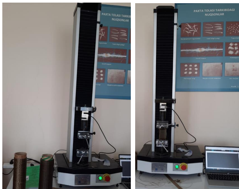
1-расм. Базальт ипларининг нисбий узилиш кучини аниқловчи WDW-5E ускунаси
