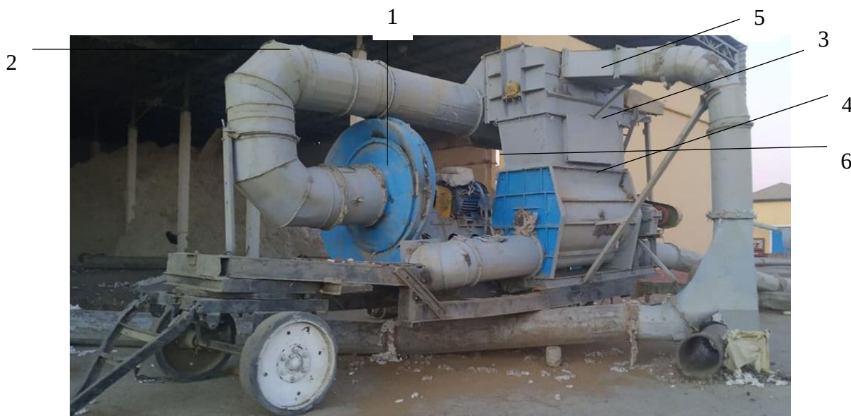
3-расм. Гиждивон туманида жойлашган пахта тозалаш заводида ўрнатилган такомиллашган кўзгалувчан қурилма
