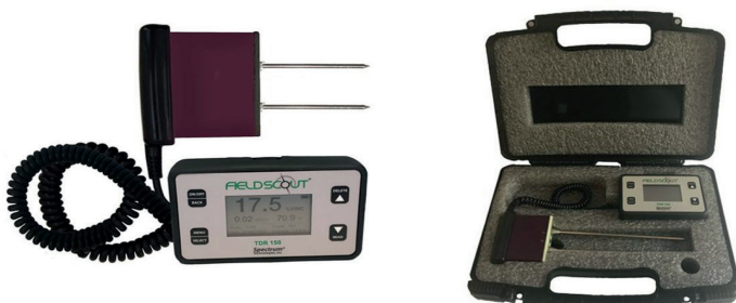
8-расм. TDR 150 – Влогмернинг кўриниши
