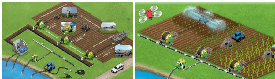
38-расм. Барабан типдаги кўчма (мобил) ёмғирлатиб суғориш тизимининг ишлаш схемалари
