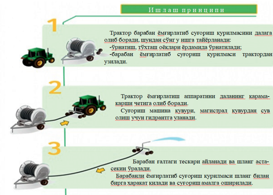
40-расм. Барабан типдаги кўчма (мобил) ёмғирлатиб суғориш тизимининг ишлаш тартиби
