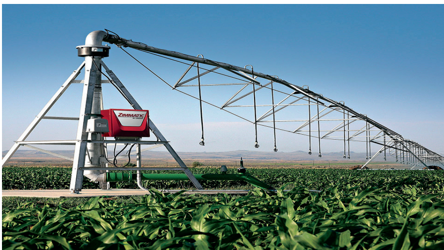
1-расм. Марказий ҳаракатланувчи ёмғирлатиб суғориш тизими (Pivot)
