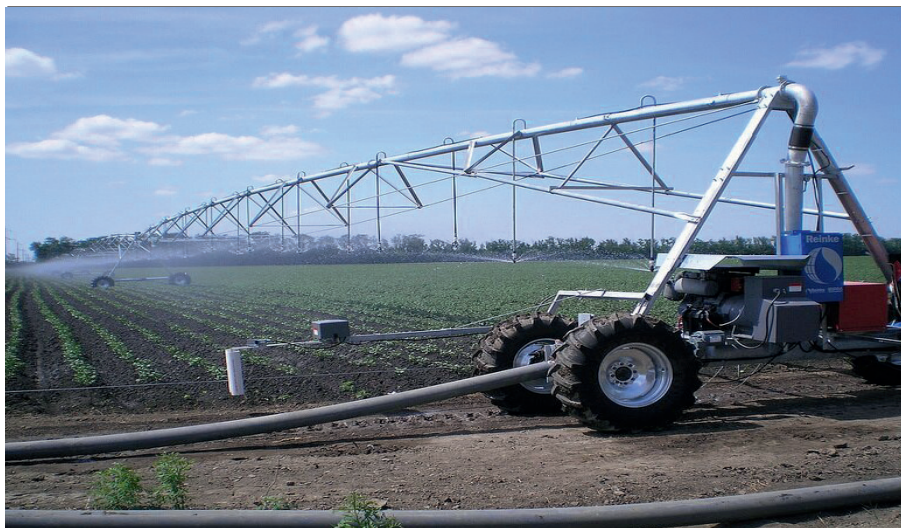
2-расм. Фронтал ҳаракатланувчи ёмғирлатиб суғориш тизими (Linear Move)
