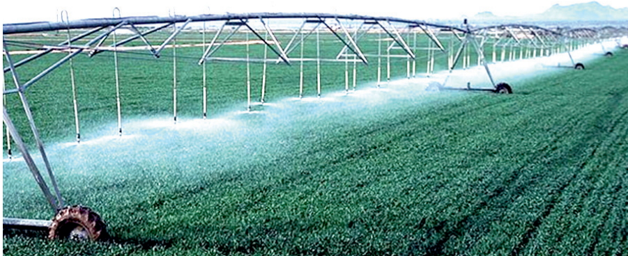
26-расм. Pivot тизими орқали куғги буғдойни ёмғирлатиб суғориш
