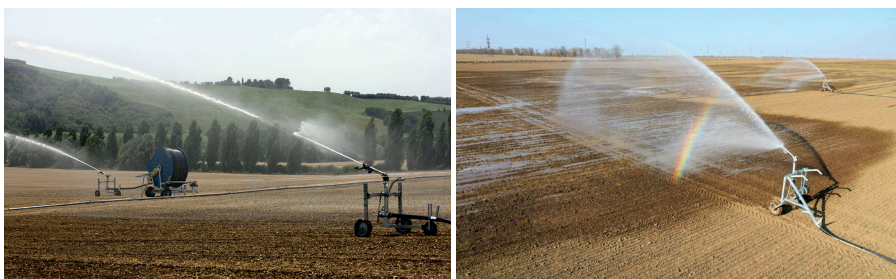
18-расм. Мобил (кўчма ва ярим кўчма барабанли) ёмғирлатиб суғориш тизимлари
