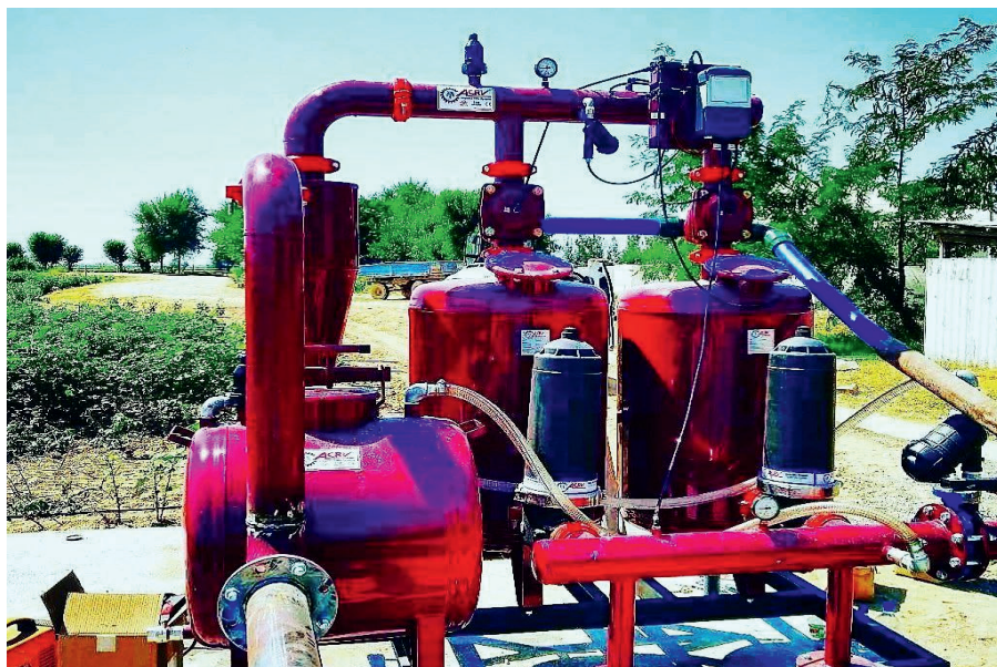
Томчилатиб ва ёмғирлатиб суғоришда ўз-ўзини ювувчи фильтр ускунаси
