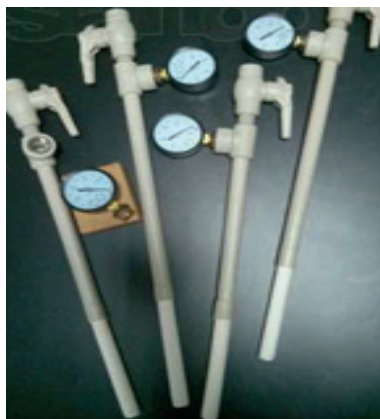
9-расм. Тупроқ намлигини тезкор аниқлаш имконини берувчи турли марказдаги тензиометрлар
