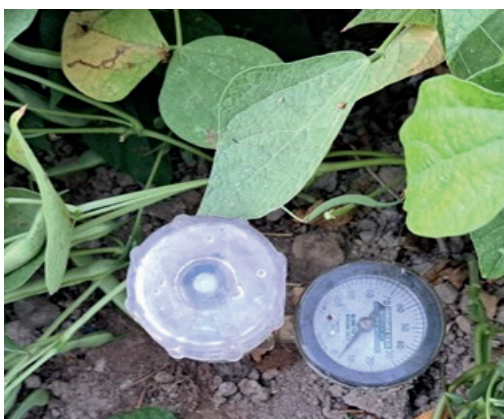
9-расм. Тупроқ намлигини тезкор аниқлаш имконини берувчи турли марказдаги тензиометрлар
