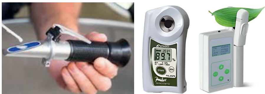
6-расм. Ғўза баргининг физиологик кўрсаткичлари бўйича суғориш муддатларини аниқлайдиган рефрактометрлар
