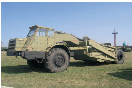
18-расм. Ер текислашда ишлатиладиган ўзиюар скреперлар
