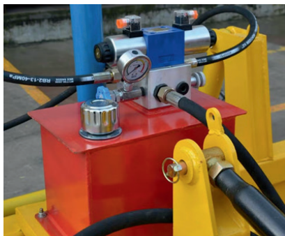
28-расм. Электрогидроклапан (соленоид гидроклапан)
