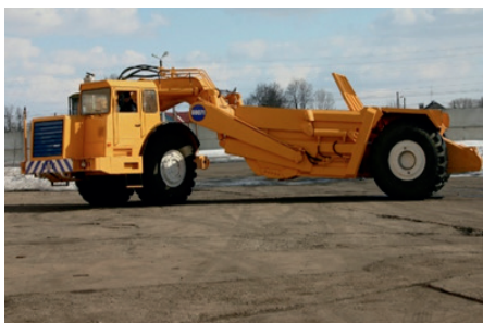
18-расм. Ер текислашда ишлатиладиган ўзиюар скреперлар
