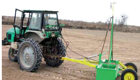
8-б). Лазер ускунаси билан жиҳозланган ер текислагичларда текислаш ишларини якка тартибда амалга ошириш жараёни
