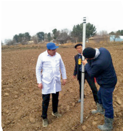
31-б). Телескопик рейкага ўрнатилган ресивер ёрдамида топографик ўлчов ишларини олиб бориш жараёни
