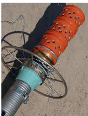
13-расм. Насосга сув тўлдириш учун қўлланиладиган қопқоқ:
