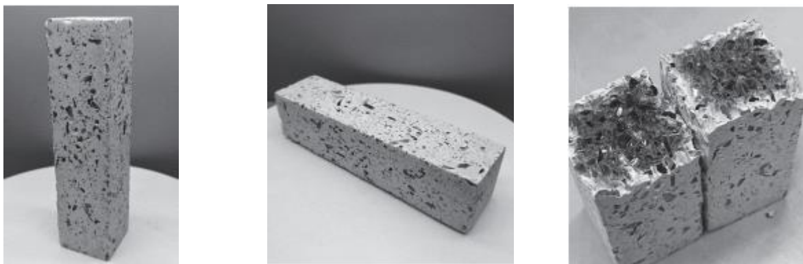
Рисунок 2. Внешний вид образца бетона из шлакощелочного вяжущего и стекольного боя
