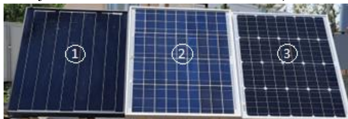
1-himoya qoplamasi qora rangli monokristall PV moduli, 2-polikristall PV moduli, 3-himoya plyonkasi oq rangli monokristall PV moduli.
