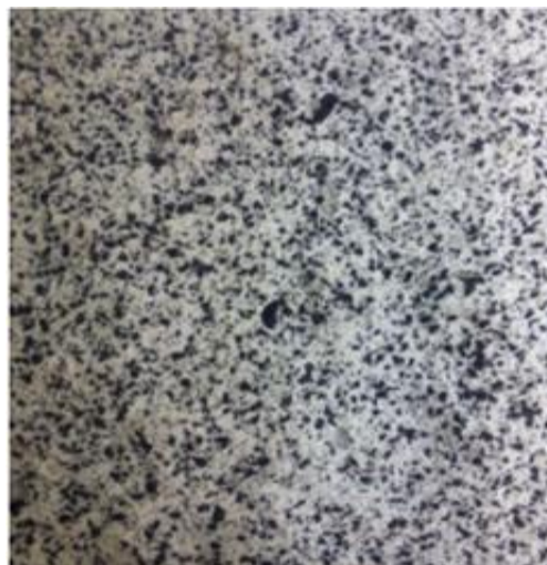
Рис. 4. Структура гипсового композита при введении 20% резиновой крошки фракции 0,8 мм
