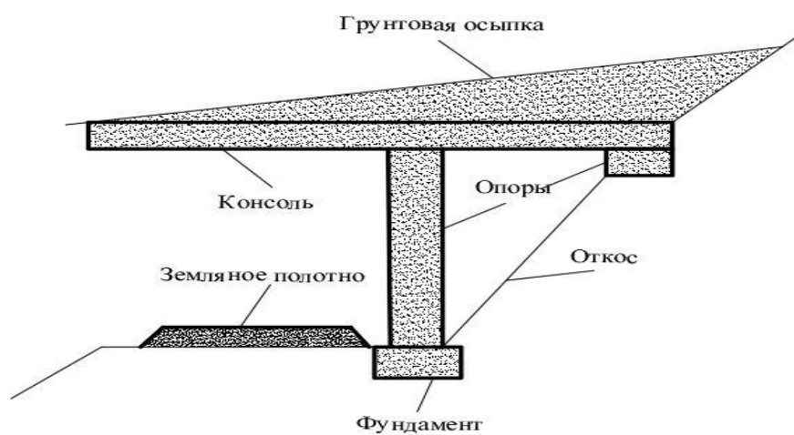
Рисунок 3. – Консольная галерея с центральной опорой
