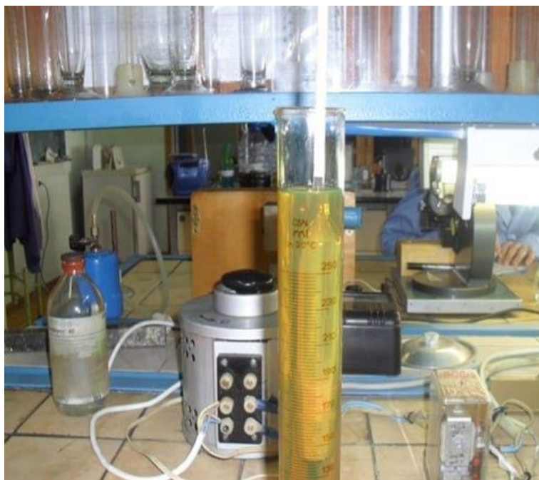
2.2-расм. Нефть маҳсулотининг зичлигини аниқлаш асбоби:
