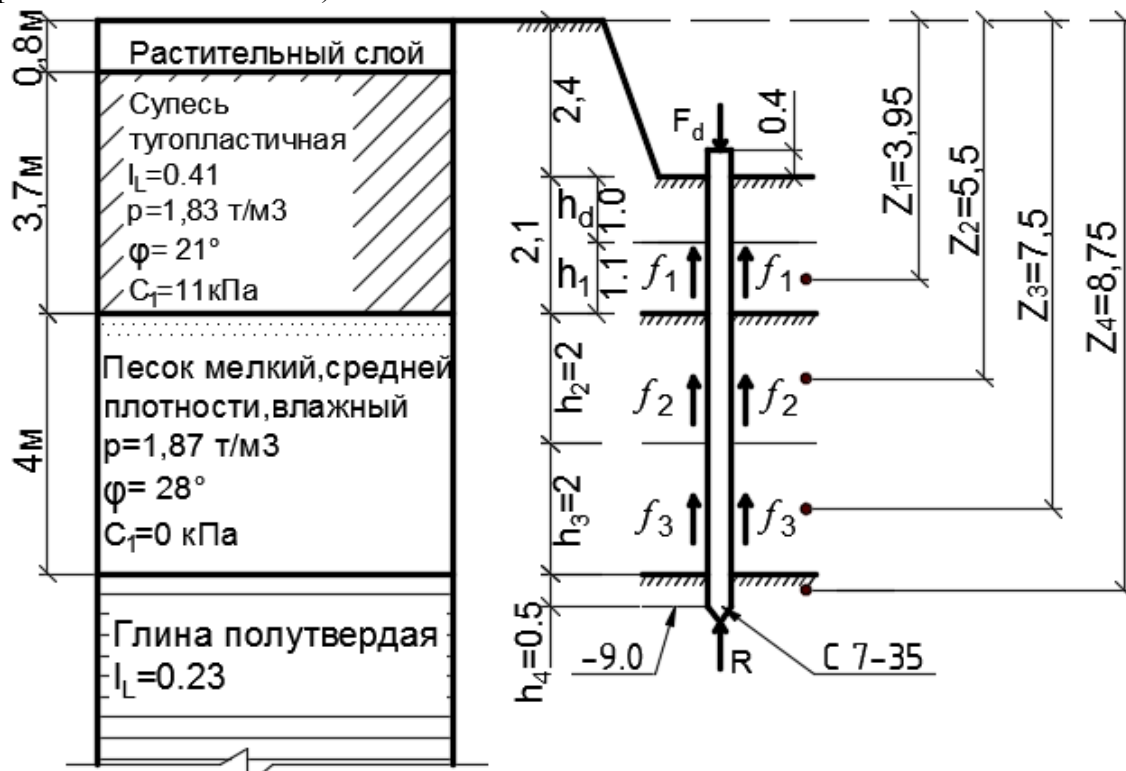
Рисунок 1. Расчетная схема сваи
