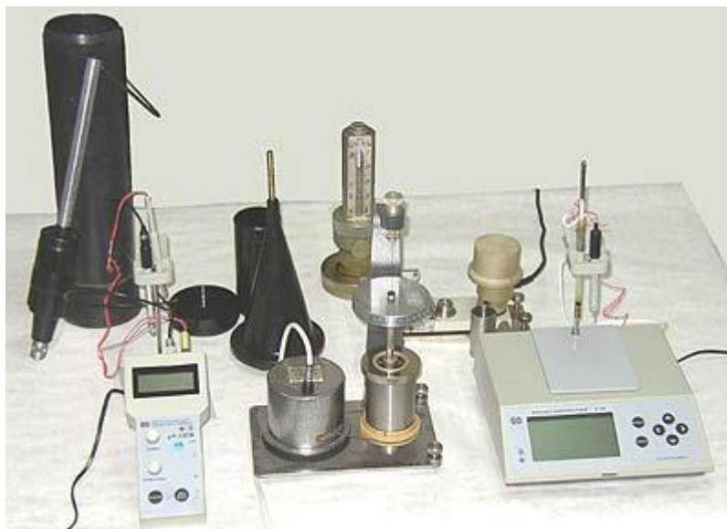
1-rasm. Yengillashtirilgan burg'ilash eritmasining ko'rsatkichlarini sinovdan o'tkazish va tadqiqot qilish uchun o'lchash jixozlari to'plami
