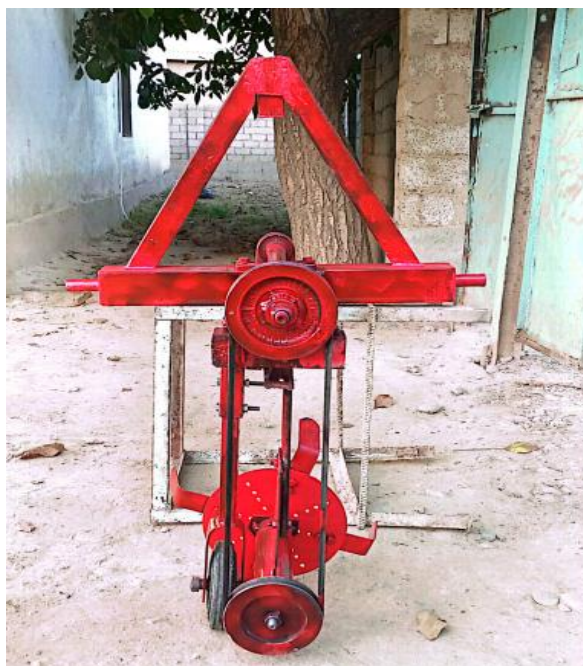
1-rasm. Qiya rotorli somon o'rgichning tajriba nusxasi.
