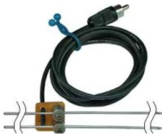
4-rasm. Tuproqning namligini(uning qarshiligi orqali) o‘zgaruvchan tokda o‘lchash uskunasi tashqi ko‘rinishi.
