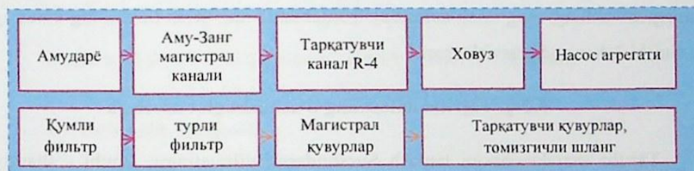
3.3-rasm. Xo'jalikda g'o'zani tomchilatib sug'orish uchun suv olib kelish tizimi ketma-ketligi.
