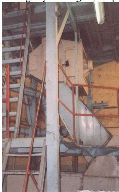
1.2-rasm. Kondensatordan keyin tolalarni namlash uchun o'rnatishning tashqi ko'rinishi va diagrammasi
