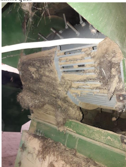
a) Kolosnik tirqishiga ifloslikni tiqilib qolish jarayoni
