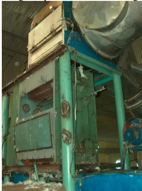
1.4-rasm. Bo'ka paxta zavodining texnologik liniyasida presslashdan oldin tolani namlash uchun tajriba zavodining tashqi ko'rinishi
