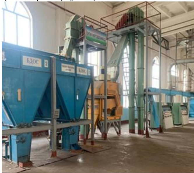
1-rasm. Tukli urug'lik chigit tayyorlash texnologik tizimi
