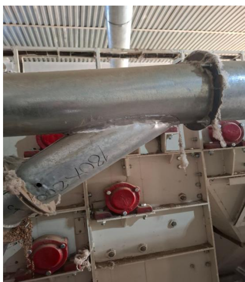
2-rasm. UXK agregatini mayda iflosliklardan iflosliklarni so'ruvchi boshlang'ich pnevmoquvurini 180 mm va 200 mm li variantlarini ko'rinishi
