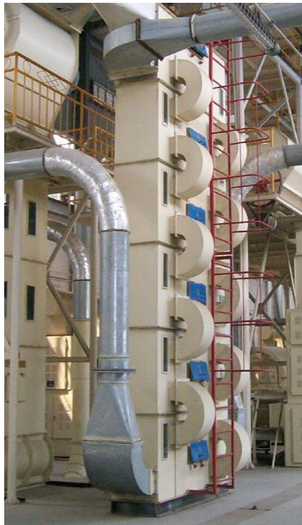
1.3-rasm. Paxtani qayta ishlash liniyasining tarkibiy qismi bo'lgan tokchali tola namlagichining ko'rinishi
