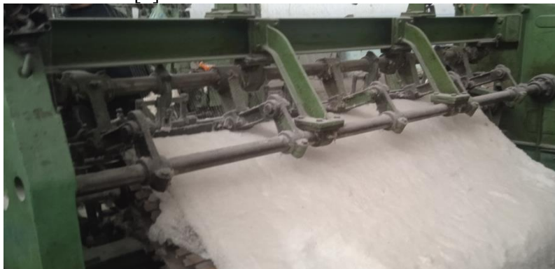
Рисунок 3. - Способ производства хлопчатобумажного ватина с применением пуха изготовленного мокрым способом
