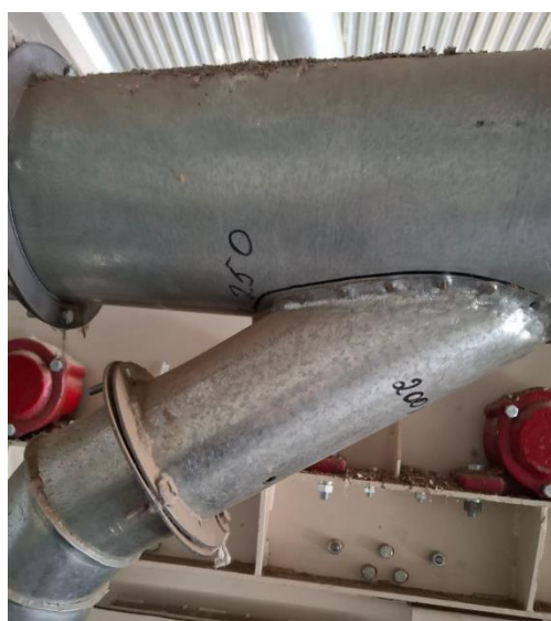
2-rasm. UXK agregatini mayda iflosliklardan iflosliklarni so'ruvchi boshlang'ich pnevmoquvurini 180 mm va 200 mm li variantlarini ko'rinishi
