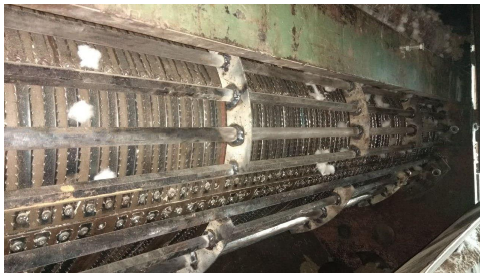
1-rasm. Taklif etilgan konstruksiyali kolosniklarni o'rnatish jarayoni
