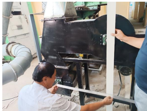
1-расм. Оғир аралашмаларни туткич қурилмасининг вакуум-клапани ва узун қозиқли барабани ўқлари орасидаги масофа 700 мм га тенг бўлган вариантыни кўриниши
